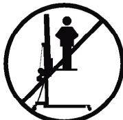
**3.1** - La torre elevadora TE-06 es una máquina diseñada para la elevación de cargas en dirección vertical. NUNCA se debe utilizar como plataforma eleavadora de personas.
